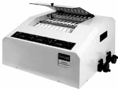
Рис. 2. Контрольно-тестовая «трепально-крутильно-сгибальная» машина Twister производства Datacard
